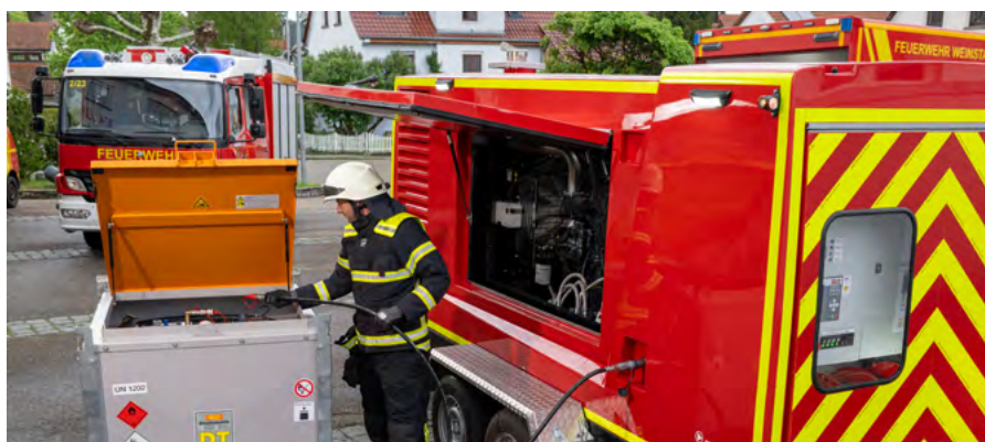
Der DT Mobil PRO Katastrophenschutztank in Anwendung: Hier Anschluss an Stromerzeuger
