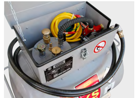
Pumpenkasten (KS-Mobil 2001) mit Elektropumpe 12 V, 25 l/min, ATEX, 4 m Abgabeschlauch und Automatik-Zapfpistole
