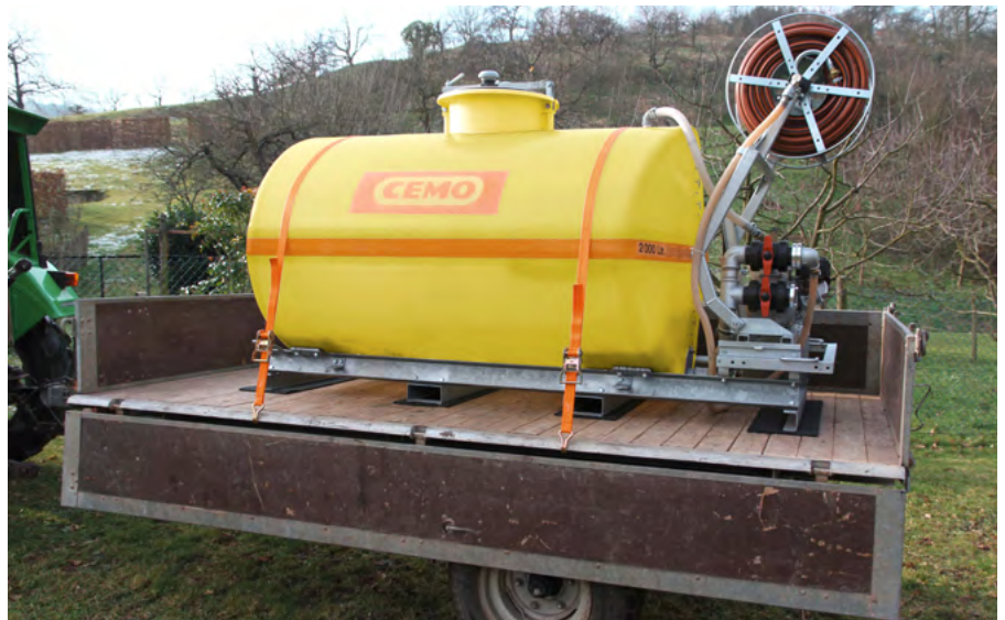
Ladungssicherung mit Antirutschmatte und Zurrgurten (Niederzurren) am Beispiel eines Mobilien Bewässerungssystems 2.000 Liter
