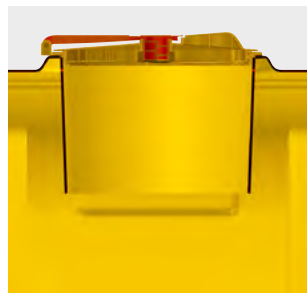
Dom mit Schwallschutz und Klappdeckel
